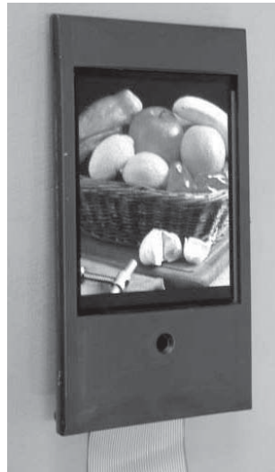
Figuur 5: Voorbeeld van een Active Matrix display: 2,6 inch diagonaal en 176 x 220 pixels resolutie.
