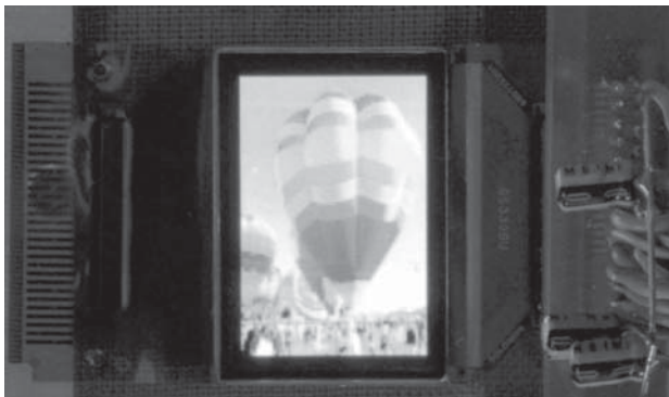
Figuur 4: Voorbeeld van een klein kleurendisplay (1,5 inch 96 x 64 pixels).
