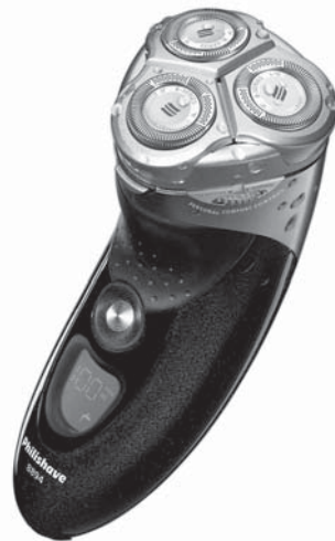
Figuur 2: De Philishave Sensotec HQ8894: het eerste commerciële product met een PolyLED display.
