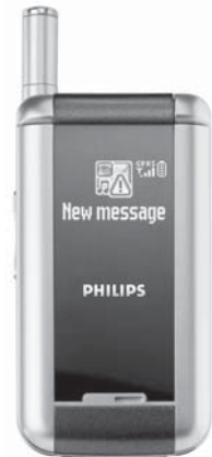
Figuur 3: De Philips 639 mobiele telefoon met "magic mirror" en een extern monochroom PolyLED display (1 inch, 48 x 80 pixels).
