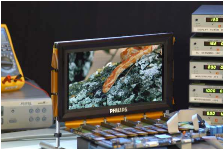
Figuur 1: Demonstrator van een PolyLED TV, Active Matrix, 13 inch , 576x324 resolutie, 16:9 breedbeeld formaat.
